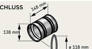
Der Maueranschluss wird an die Rauchfangöffnung angebracht und benötigt keine weiteren Dichtungen. Sauber und einfach. Die Innenseite verfügt an beiden Enden über eine Dichtung. Der Maueranschluss kann an der hinteren und der oberen Verbindung eingesetzt werden.
